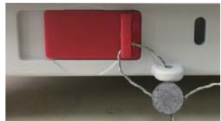
Bloqueado con cable de sellado
