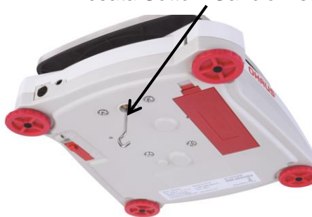
Pesata Sotto il Gancio installato
