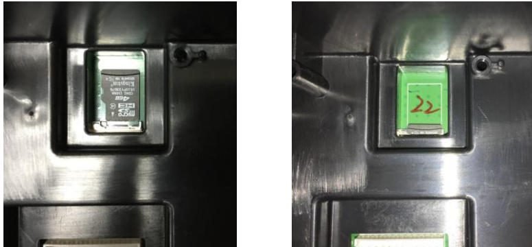
Abbildung 2-5 Einschoben einer SD-Karte in die SD-Buchse (links); SD-Karte installiert (rechts)
