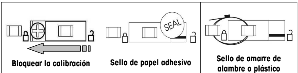
Figura 4-1. Bloqueo y sellado del interruptor del seguro de calibración.
