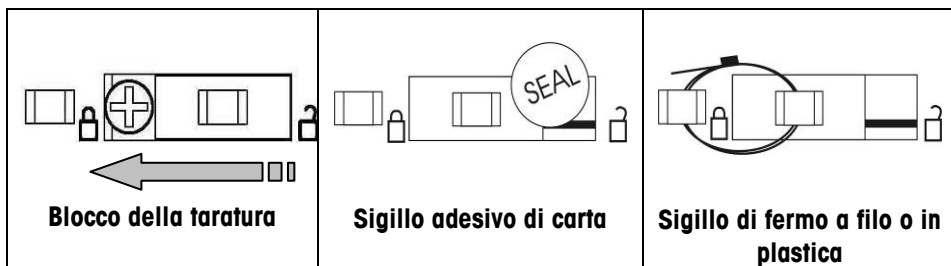
Figura 4-1. Blocco e sigillo dell'interruttore di blocco della taratura.
