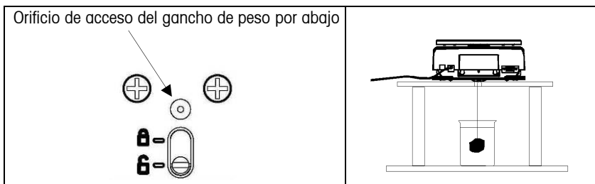
Figura 4-2. Configuración para usar el gancho de peso por abajo.
