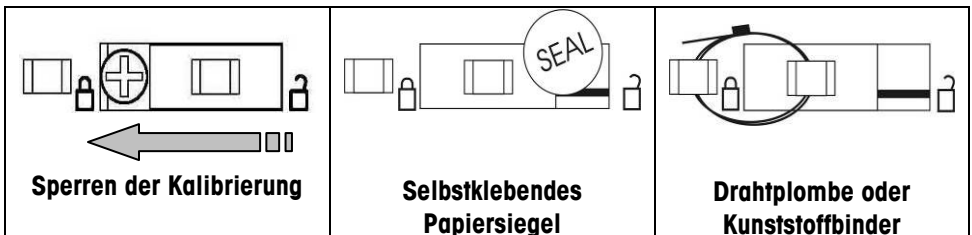
Abbildung 4-1. Sperren und Versiegeln des Kalibrierungssperrschalters.
